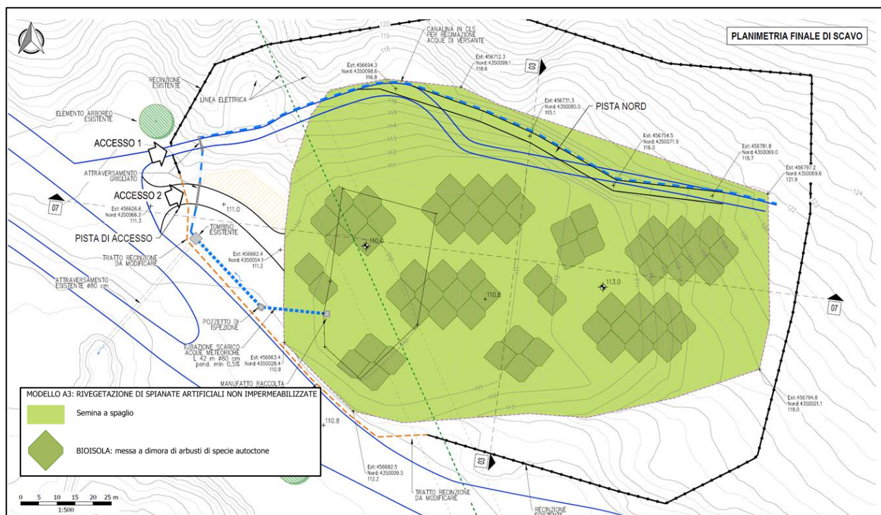
FIGURA 69 PLANIMETRIA DEGLI INTERVENTI DI RINATURAZIONE DA EFFETTUARSI NEL CdP 13 DI MONTE AGRUXAU
